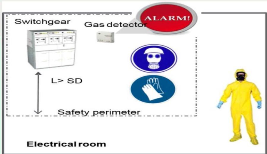
Рис.5 Демонстрация электрической комнаты с периметром безопасности вокруг электрического распределительного устройства при обнаружении утечки газа
