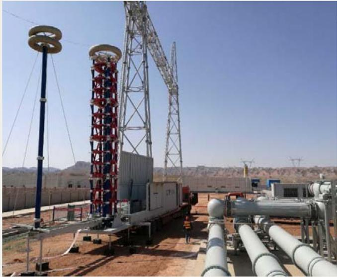
рис. 18 а) автомобильный импульсный генератор
