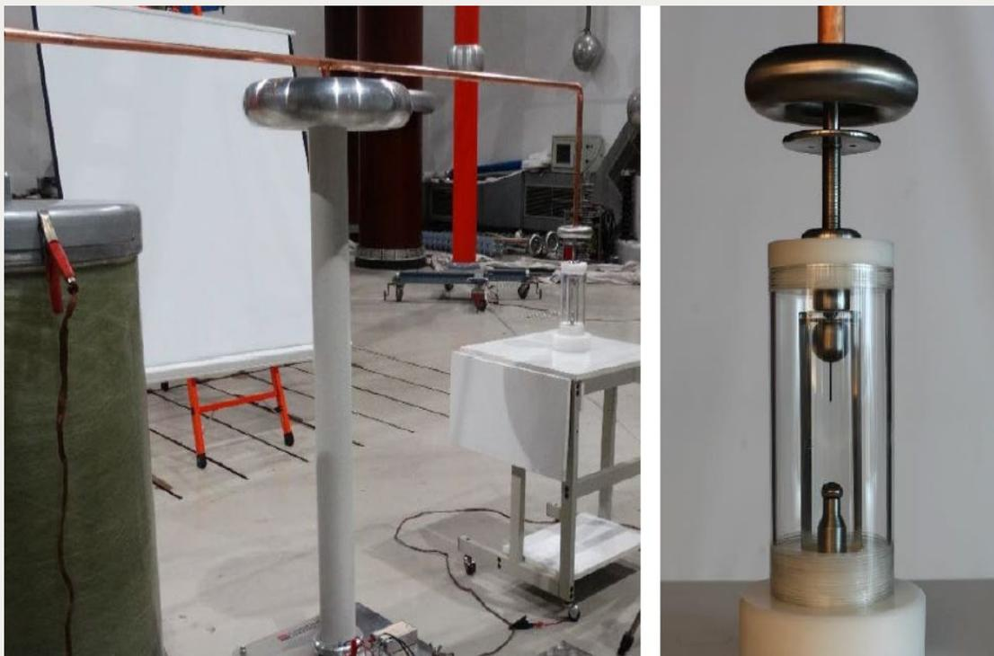
Рис.8 (слева) испытательная установка, используемая для измерения ЧР, (справа) Испытательная ячейка (IEC TR61294), изготовленная в соответствии со стандартными требованиями
