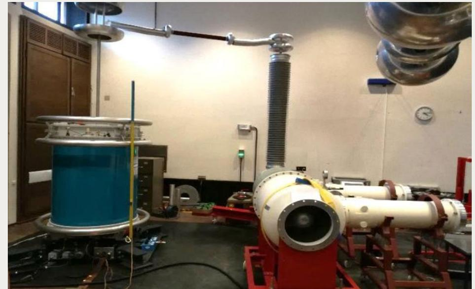
**Рис.1 Система изоляции постоянного тока: испытательная установка (слева) и подключение импульсного напряжения во втором испытательном зале (справа)**
