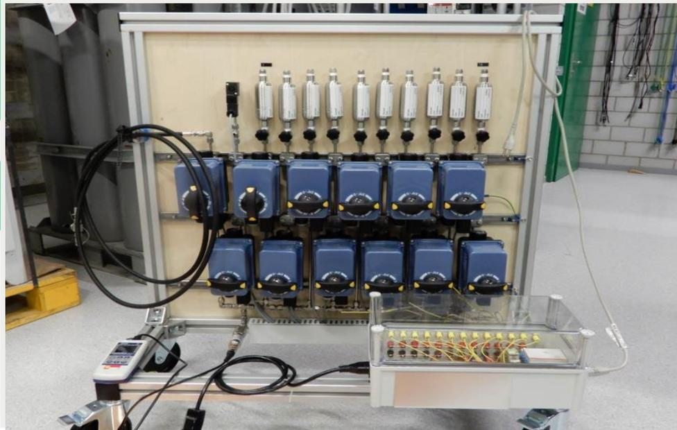
Рис.7 Фотография оборудования для отбора проб газа, используемого для дистанционного и автоматического получения образцов газа во время испытаний на короткое замыкание
